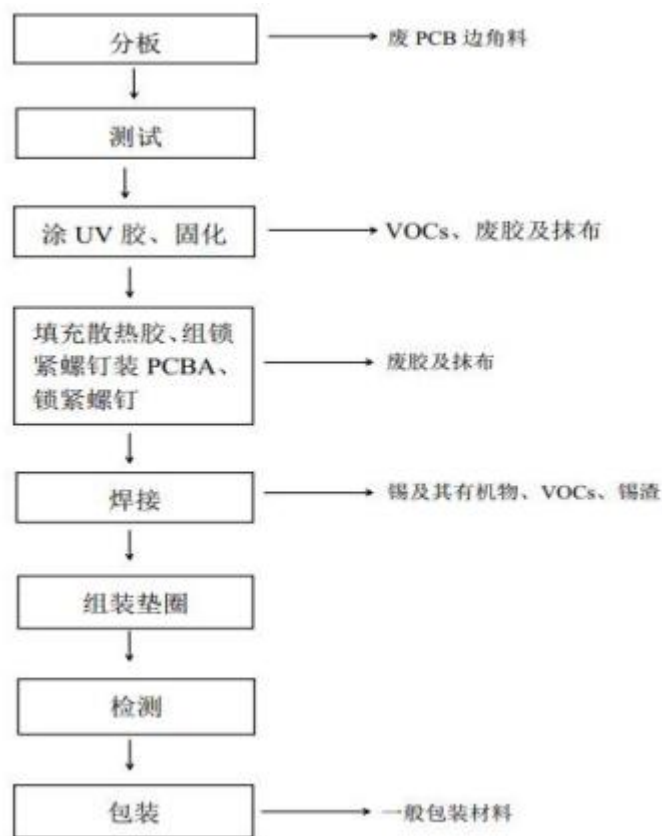
图 2-13 现有项目汽车日行灯与示廓灯生产工艺流程图
