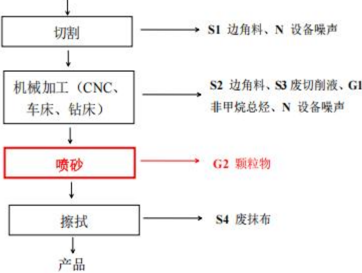
图 2-8 现有项目亚克力模型/铝模型生产工艺流程图
